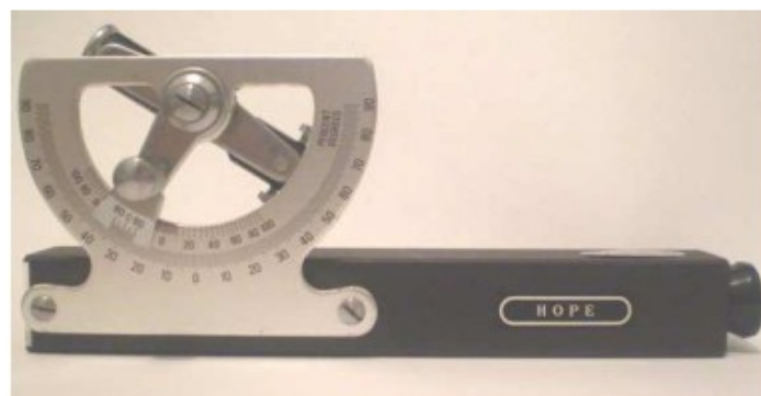
Figura 05 – Modelo de Clinômetro.
